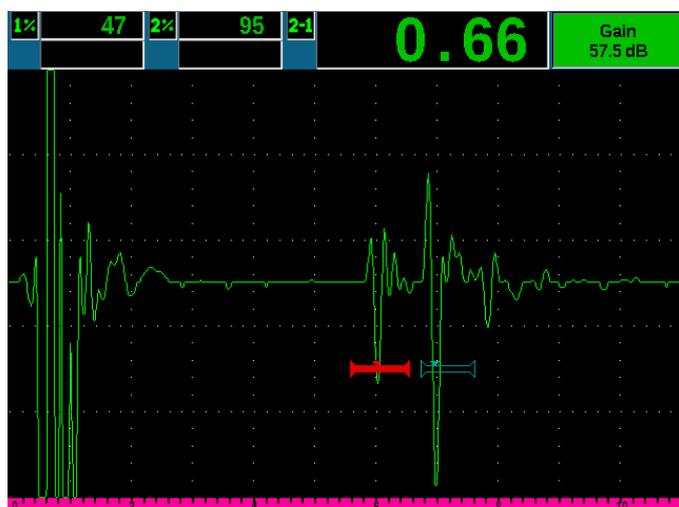
使用探伤仪和M2017延迟块探头完成典型的内壁氧化层测量，屏幕左侧的信号为延迟块回波
