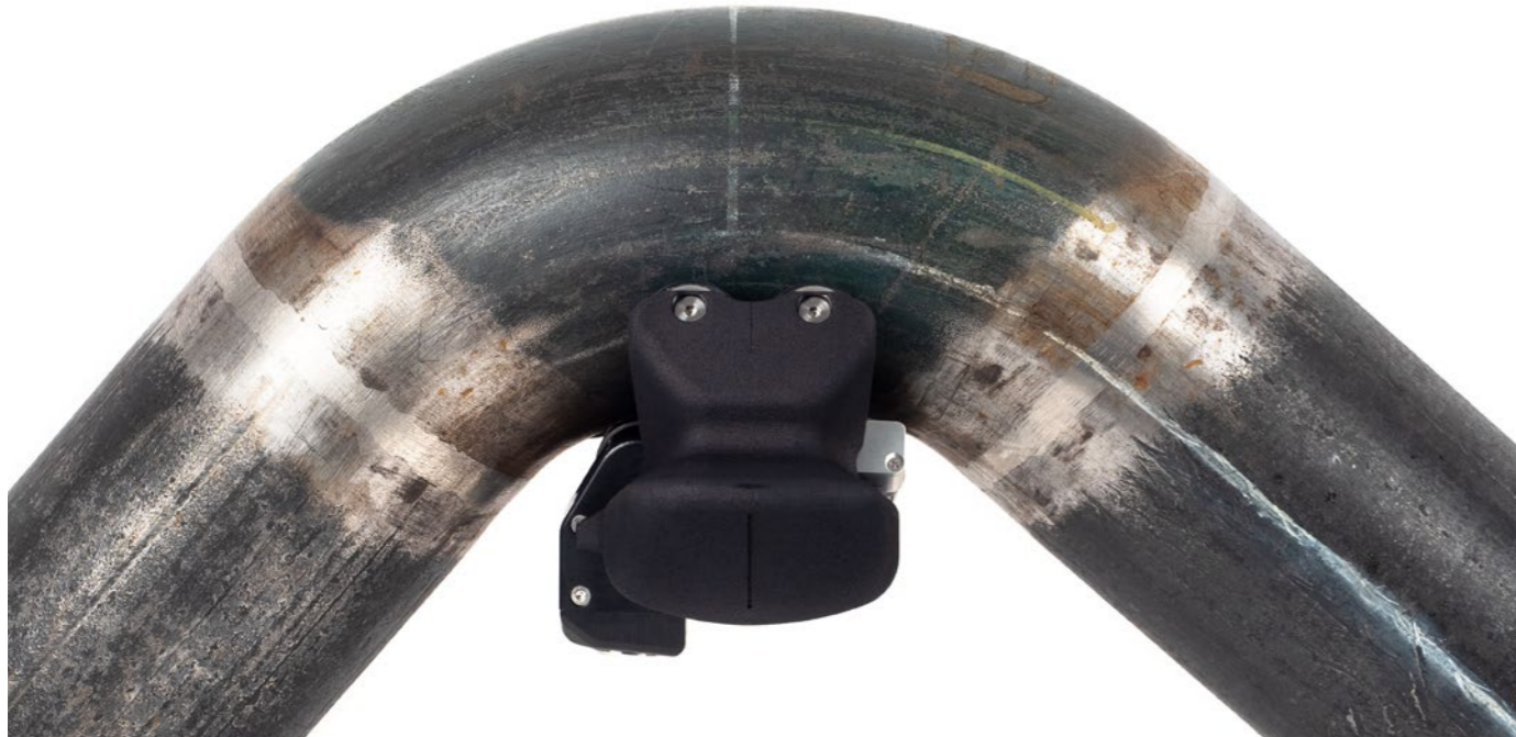
Escáner FlexoFORM inspeccionando el intradós de un codo de tubería con un diámetro externo de 4,5 pulg.
