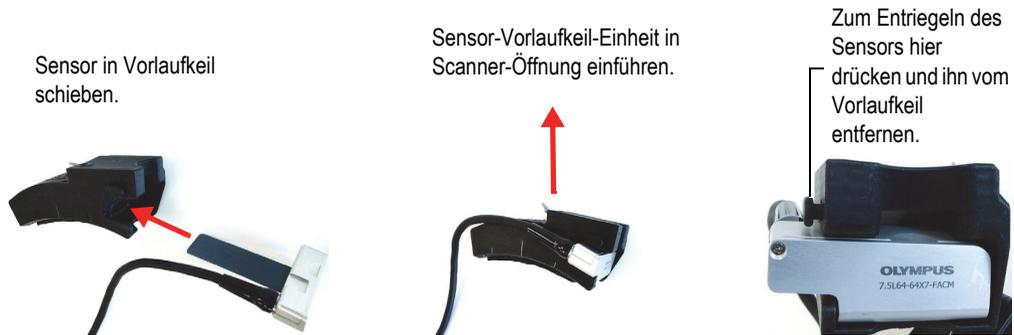
**Abbildung 2-3 Sensor und Vorlaufkeil installieren**
