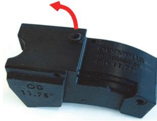
Abbildung 5-5 Austauschen der O-Ring-Dichtung für den Wasserschlauchanschluss
