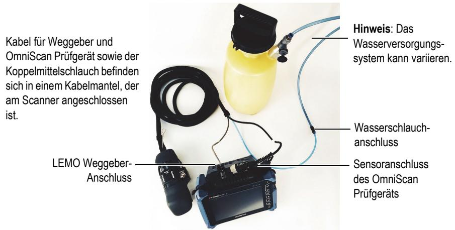
**Abbildung 2-4 Scanner mit angeschlossenen Komponenten (Beispiel)**
