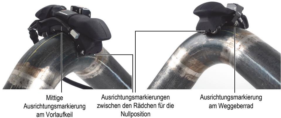
**Abbildung 4-2 Ausrichtungsmarkierungen**
