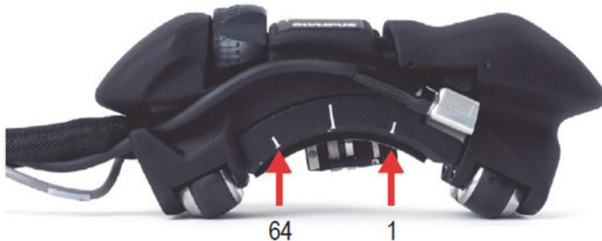
**Abbildung 4-3 Ausrichtungsmarkierungen mit dem OmniScan X3**
