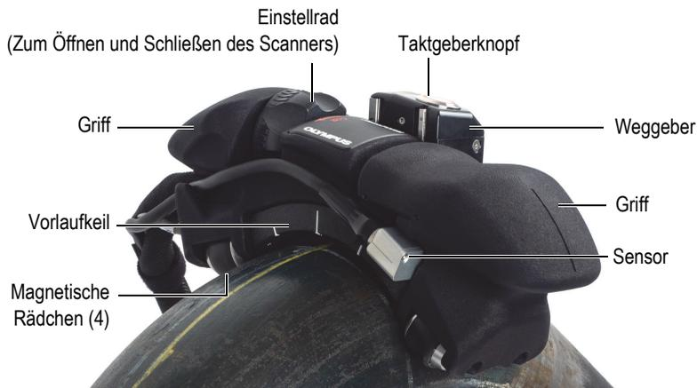
**Abbildung 1-2 Komponenten des Scanners**
