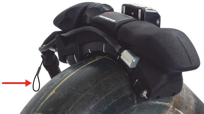
Figura 3-1 Punto di fissaggio del cordino
