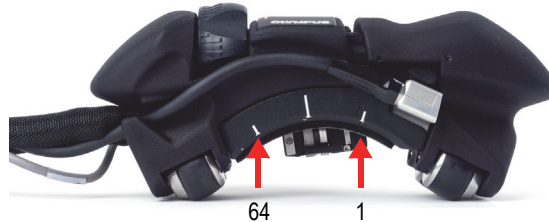
Figura 4-5 Indicazioni degli elementi della sonda sullo zoccolo
