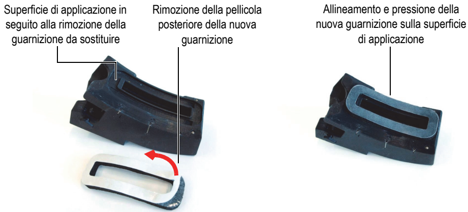
Figura 5-3 Sostituzione della guarnizione di poliuretano
