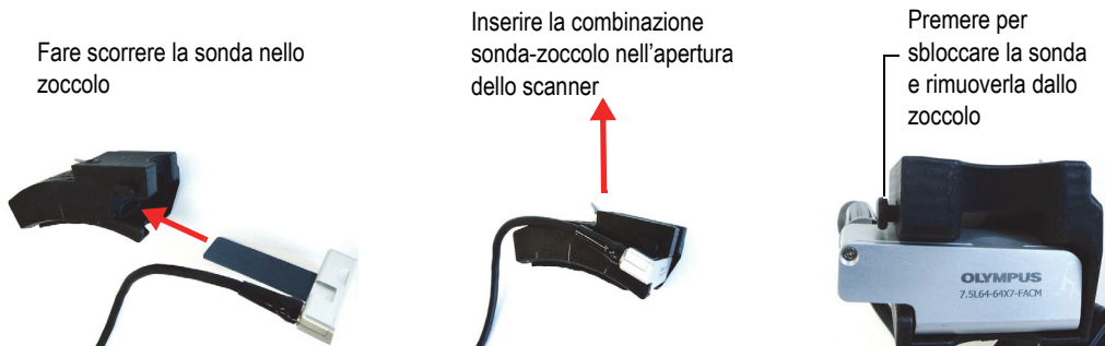
Figura 2-3 Installazione della sonda e dello zoccolo
