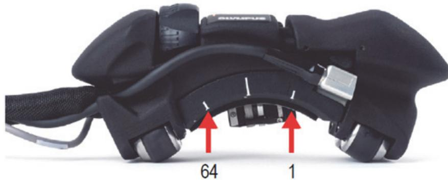
**Figura 4-3 Marcas de alinhamento a serem usadas com o instrumento OmniScan X3**
