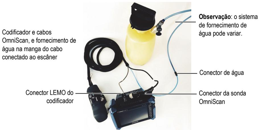
**Figura 2-4 Exemplo de conexões do escâner**
