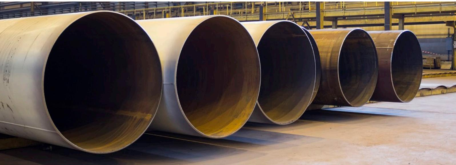
Os tubos soldados por arco submerso longitudinal (LSAW, sigla em inglês) são fabricados dobrando e moldando chapas de aço e unindo as bordas usando uma solda de arco submerso de dupla face. O processo de solda por arco submerso longitudinal fornece aos tubos de aço excelente ductilidade, uniformidade, plasticidade, resistência à solda e vedação. Os tubos LSAW são comumente usados na indústria de petróleo e gás devido à eficiência no transporte de longa distância de hidrocarbonetos.
