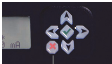
Pulsante d'interruzione dell'alimentazione per l'arresto di emergenza
