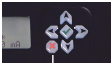
停止/緊急遮断ボタン
