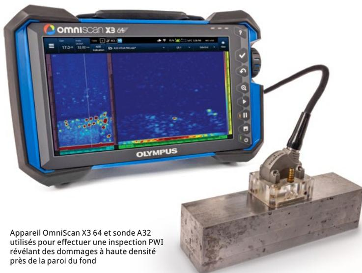
Appareil OmniScan X3 64 et sonde A32 utilisés pour effectuer une inspection PWI révélant des dommages à haute densité près de la paroi du fond
