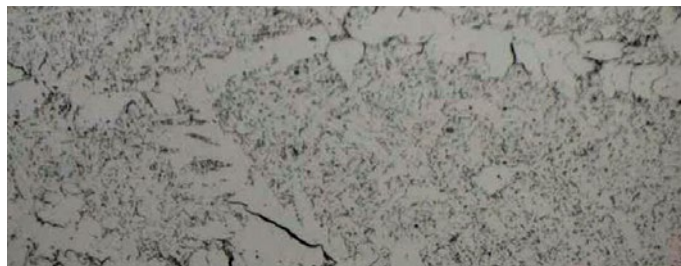
Imagem da micrografia de dano por HTHA
