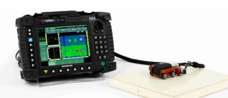
Para cada C-scan, o operador tem duas opções de visualização: o C-scan da amplitude exibe variações de cores de acordo com a amplitude do sinal, independentemente da fase, que é ideal para detecção clara e eficiente do descolamento; ou o C-scan da fase usa a paleta de cores – de 0° a 360° – para mostrar as mudanças do ângulo da fase, facilitando a distinção entre os diferentes tipos de indicações, como delaminação e massa (reparos).
