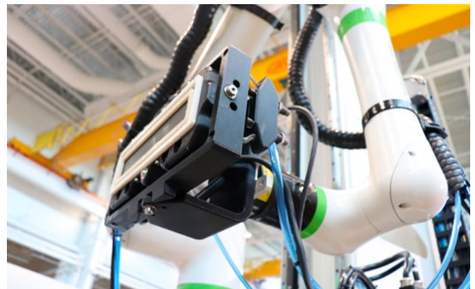
Sonda Phased Array y suela/zapata que se encuentran montadas en el brazo robótico del AGV, que además viene con una unidad de adquisición de datos FOCUS PX incorporada (no se muestra)
