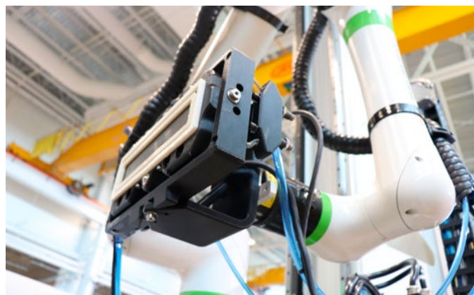
安装在AGV协作机器人臂上的相控阵探头和水楔, 同样配备了 FOCUS PX 数据采集单元 (未显示)
