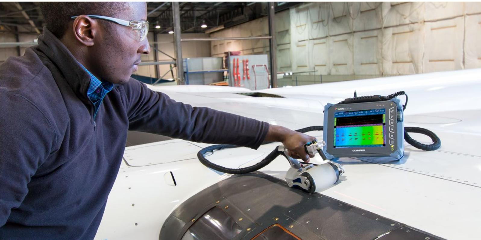
Der RollerFORM Phased-Array-Rollsensord von Olympus wurde für die Prüfung von Verbundwerkstoffen und anderen Materialien mit glatter Oberfläche entwickelt. Der RollerFORM Scanner ist ein kostengünstiger Ersatz für ein komplettes 2D-Weggebersystem und eine praktische Alternative zur Tauchtechnik.
