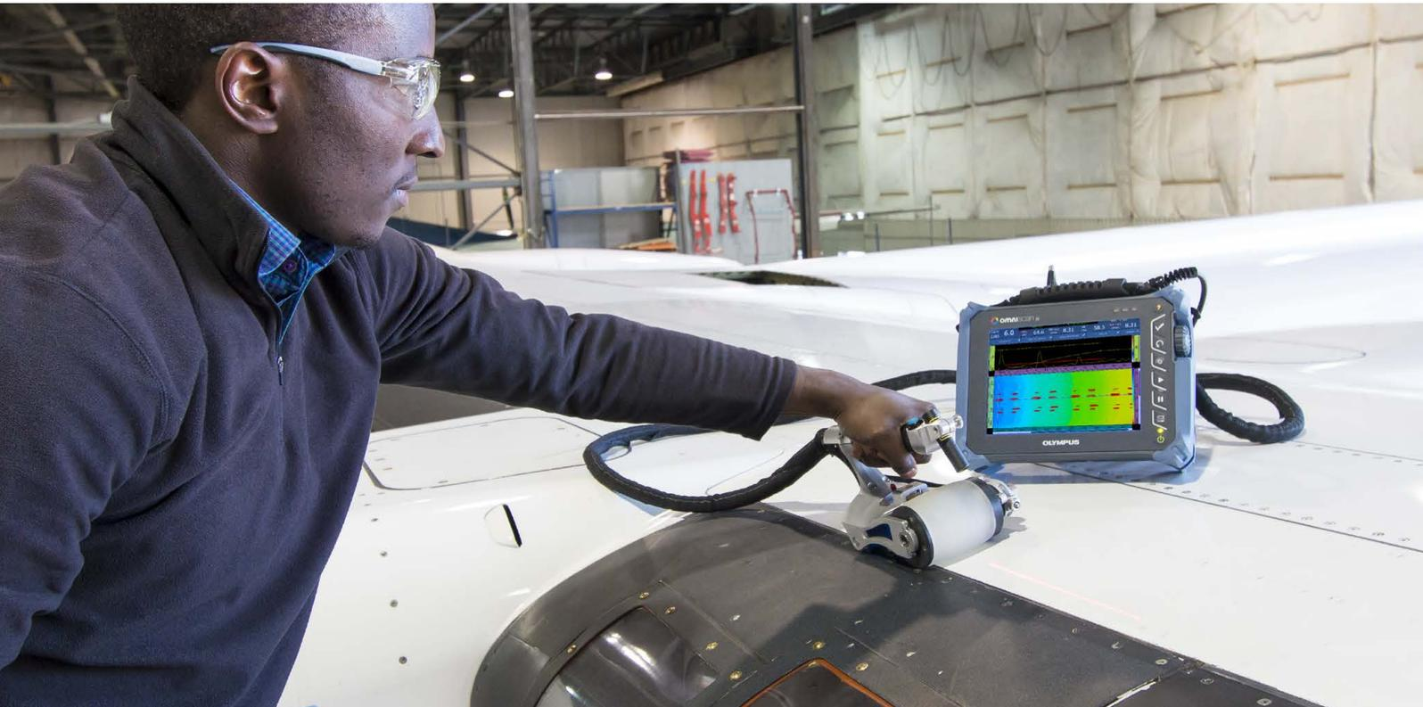
オリンパスは、複合材料や表面が滑らかな材料の検査に適応した新しいホイール型フェーズドアレイプローブ RollerFORM を提供します。コストパフォーマンスに優れ、なおかつ、簡単に使用開始することが可能で、2軸のエンコーティングシステムを置き換えるものであると同時に、水浸技術に置き換わる新しく効率的な検査が可能です。
