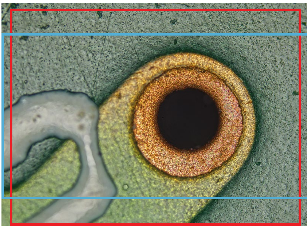
O campo de visão da câmera DP75 quando usada com o adaptador de câmera 0,63× (quadro vermelho) em comparação ao campo de visão da câmera DP74 (predecessora) quando usada com o adaptador de câmera 0,63× (quadro azul)
