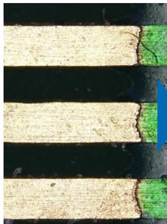
通过HDR消除光晕 (样品:印制电路板[PCB])
