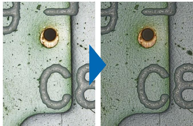
通过HDR增强质地 (样品:印制电路板[PCB])
