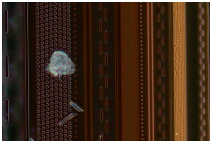
半导体晶圆上光刻胶残留物的MIX(荧光+暗场)观测图像。
