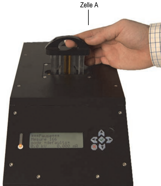
Abbildung 3-15 Einlegen der Probenzellenhalterung in die Probenkammer
