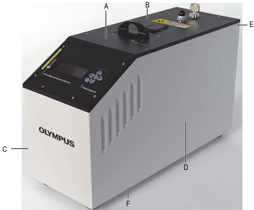
Figura 2-3 Áreas de medición de la radiación
