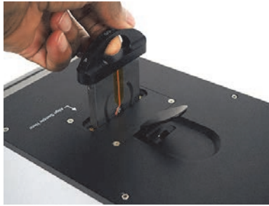
Figure 3-10 Retrait du porte-échantillon
