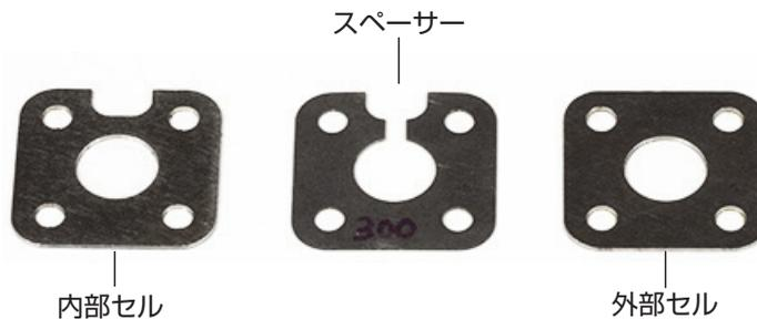
図 3-11 試料セルの部品
