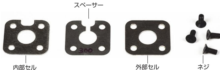
図 3-6 試料セルの部品
