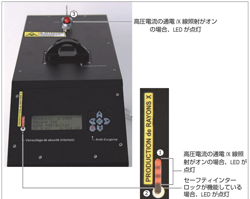
図 2-2 BTX III LED インジケータ
