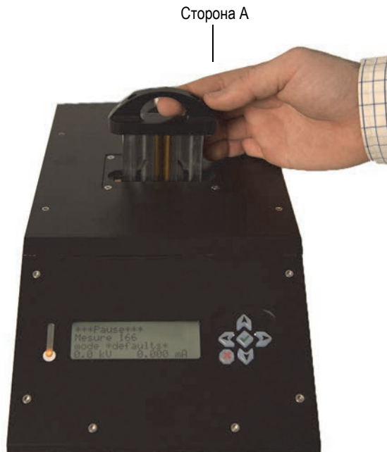
Рис. 3-15 Установка держателя образца
