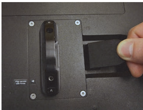
Рис. 3-16 Фиксация держателя образца
