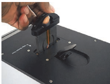
Рис. 3-10 Извлечение держателя образца
