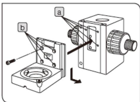
本图显示了安装用于 BAXFM-S 的照明器托架 (BAXFM-ILHS) 的步骤。安装其它照明器托架时，可以使用相同的步骤。
