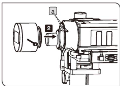
此图显示了安装反射 LED 灯箱(BX3M-LEDR) 的步骤。安装其它光源时，可以使用相同的步骤。
