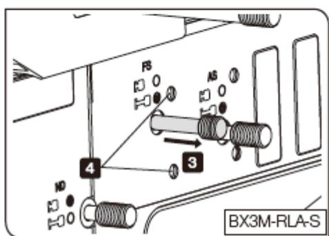
3 调节反射光照明器的视场光阑拨杆 (视场光阑拉杆)，缩小视场光阑的直径到最小。(图 A)
