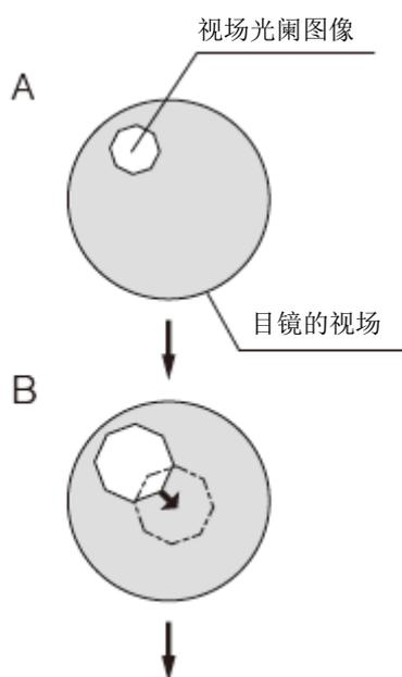
4 将六角螺丝刀插入反射光照明器的 FS 对中螺丝 (2 个)，旋转调节视场光阑图像，使其接近视场中心。(图 B)
