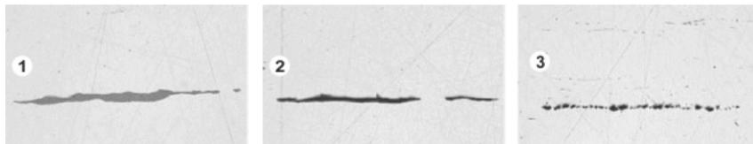
抛光钢样品中的不同夹杂物的显微镜图像。夹杂物的颜色和形状互不相同。图像示出了硫化物夹杂物 (1)、硅酸盐夹杂物 (2) 和铝夹杂物 (3)。
