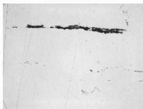
测量示例图像上的最大非金属夹杂物。
