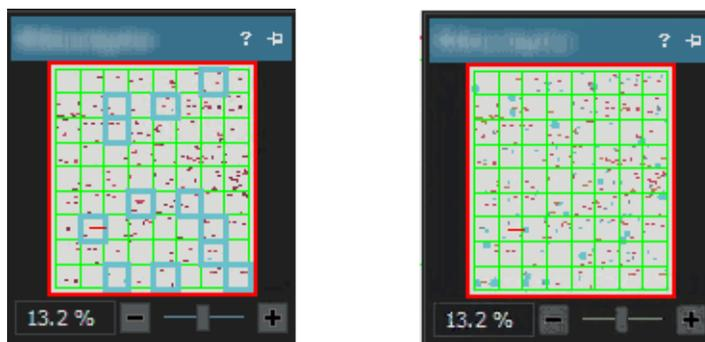
左侧的图：依照 [ASTM E 45-18 D 法] 标准或 [ISO 4967:2013 B 法] 标准执行分析时，[图像导航] 工具窗口中的结果图像。在所示的示例中，所有字段周围会显示彩色轮廓，其中检测到属于当前所选类型夹杂物的夹杂物。
