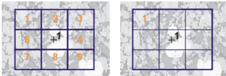
图显示了在其上定义了一个扫描区域 (1) 的样品。完整采集扫描区域需要 9 个单幅图像。在左侧，[单帧检查] 选项被选定。例如，如果执行相分析并将工作簿作为结果输出，现在您可以在样品的工作表上看到 9 幅图像的结果。在右侧，[拼接图像检查] 选项被选定。在样品的工作表上，现在只能看到相同扫描区域的一个结果，因为各个图像将首先组合为单幅图像，然后再进行分析。
