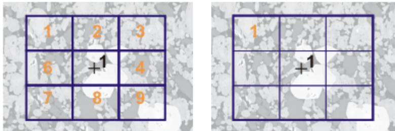
Die Abbildung zeigt eine Probe, auf der ein Scanbereich (1) definiert ist. Es sind 9 einzelne Bilder nötig, um den Scanbereich vollständig aufzunehmen.
