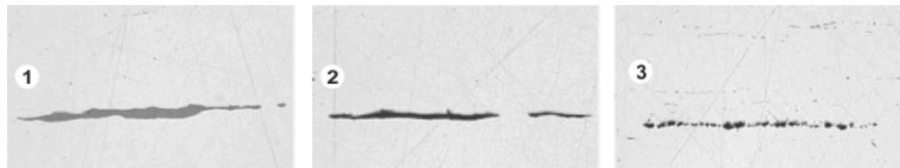
Mikroskopische Darstellung verschiedener Einschlüsse in einer polierten Stahlprobe. Die Einschlüsse unterscheiden sich in der Farbe und in der Form. Die Abbildungen zeigen einen Sulfid-Einschluss (1), einen Silikat-Einschluss (2) und einen Aluminiumoxid-Einschluss (3).
