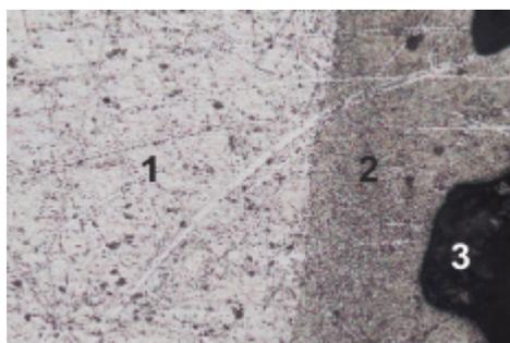
Die Abbildung zeigt das Bild von einer Probe mit den beiden Phasen (1) und (2). Die dunklen Bereiche (3) gehören zu keiner Phase. Sie möchten die Flächenbelegung der beiden Phasen (1) und (2) messen.
