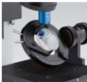
※オプションで①透過率、②45 度入射の反射率測定、③偏光方向を規定した測定をすることができます。
