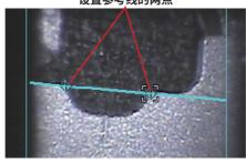
输入要在左侧测量区域中测量的点。此时,确认右侧测量区域中对应点的位置离左侧测量区域中的光标位置不远。参考线到输入点的距离将被测量。
