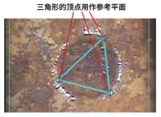
输入要在左侧测量区域中测量的点。此时,确认右侧测量区域中对应点的位置离左侧测量区域中的光标位置不远。参考平面到输入点的距离将被测量。
