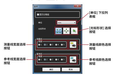
测量线的宽度(厚度)能在1和5点之间进行选择。如果立体测量目标图像中未包含任何测量结果,测量线的宽度就会设置为2点。
