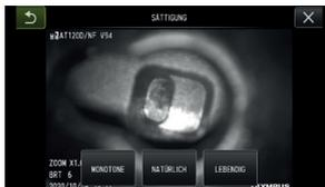
Bei Betätigung der Schaltfläche ändert sich die Sättigungsstufe.
