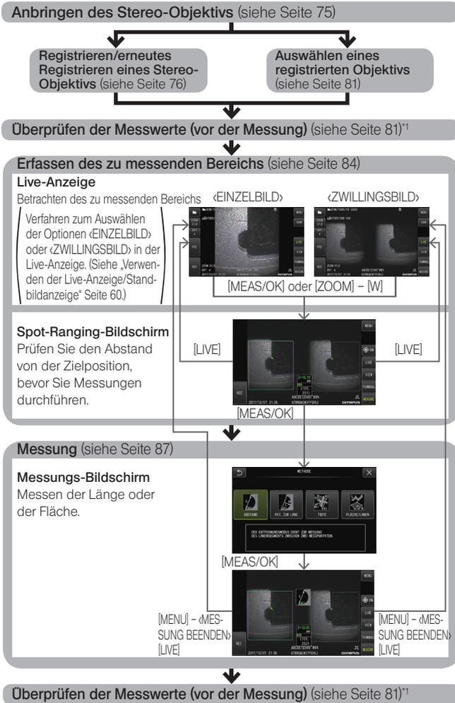
\*1 Stellen Sie sicher, dass die ermittelten Messwerte beim „Überprüfen der Messwerte (vor der Messung)“ und „Überprüfen der Messwerte (nach der Messung)“ nahezu identisch sind. Wenn die Messwerte voneinander abweichen, überprüfen Sie, dass das Stereo-Objektiv nicht locker und die Linse nicht verschmutzt ist; führen Sie die Messung bei Bedarf erneut durch.
