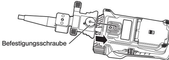
Ziehen Sie die Befestigungsschraube des Führungsrohrs an der Stativmontageöffnung der Endoskopieeinheit fest an, und stellen Sie sicher, dass das Führungsrohr fest sitzt.
