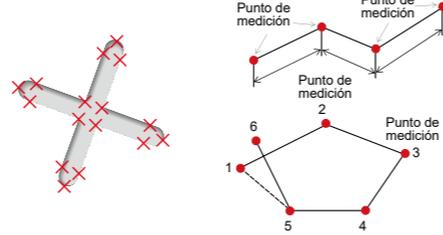
El modo Área sirve para medir el área definida por múltiples puntos de medición. El modo Líneas sirve para medir la longitud total de las líneas definidas por múltiples puntos de medición.
