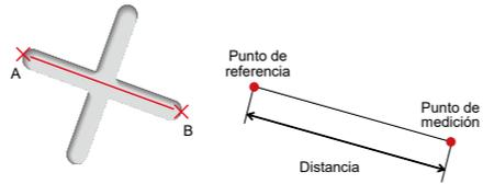
El modo Distancia sirve para medir el segmento de recta entre dos puntos de medición.
