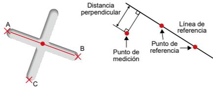
El modo Punto a Línea sirve para medir la distancia desde un punto de medición hasta la línea de referencia definida por dos puntos.
