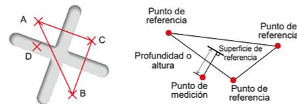
El modo Profundidad sirve para medir la distancia desde un punto de medición hasta el plano de referencia definido por tres puntos de referencia.
