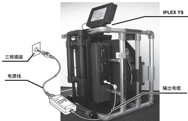
3. 待电源线连接到 AC 适配器的 AC 电源入口后，将电源线插口牢固地连接到三相 AC 电源插座上。
