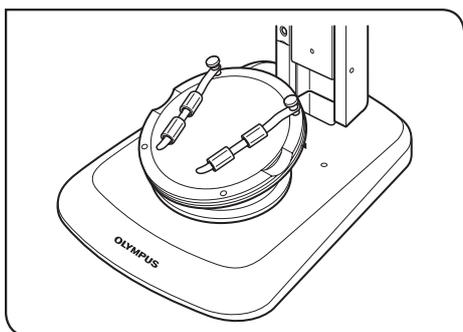
**参考** ペトリディッシュのような容器を固定する場合には、付属のチューブをクレンメルに差し込んで容器を挟み込むようにして、固定します。
