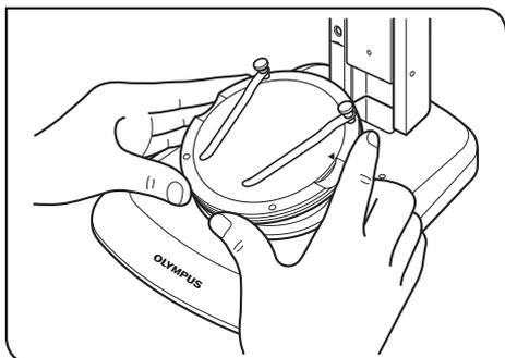
試料をステージ板の上ののせて、カップステージの縁を手で持ち、カップステージをゆっくりと傾斜させます。
