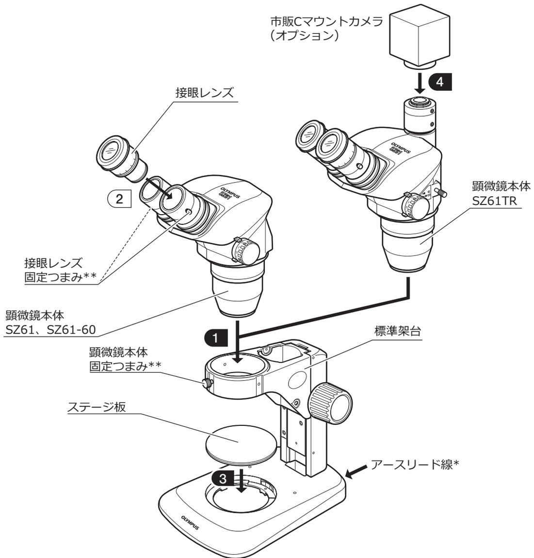
\* ESD性能を確保する場合は、 $\phi 4$ バナナプラグ付きアースリード線を使用して、必ずアース接地を行ってください。
