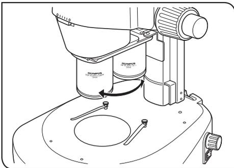
Sujete el objetivo y gírelo con suavidad hasta una posición de clic de la parte delantera en la que el objetivo a utilizar quede interpuesto en la trayectoria de luz.
