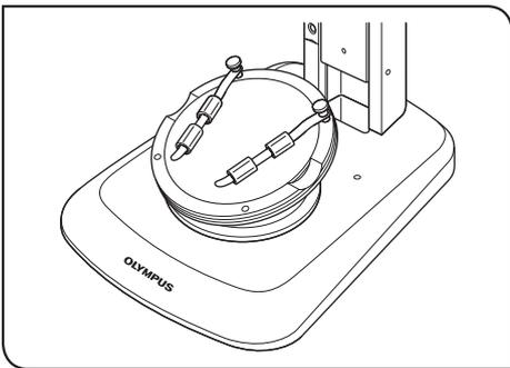
Para fijar un recipiente como una placa de Petri, inserte el tubo proporcionado en el portamuestras para fijar el recipiente a presión.
