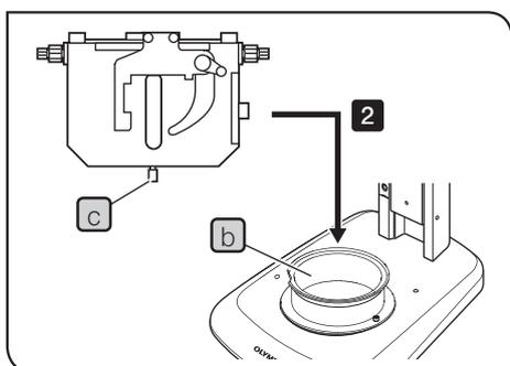
**2** Coloque el mando de fijación de la platina (c) del BH2-SH (platina de mando horizontal) en la parte frontal de la base, gire el mando de fijación (c) en sentido horario para fijarlo y monte el BH2-SH.
