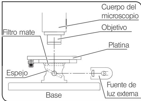
**1** Ilumine la muestra con una fuente de luz externa (iluminador LSD, iluminador de guía de luz, etc). Encienda la fuente de luz externa según se muestra en la figura de la izquierda e irradie el conjunto del espejo.
