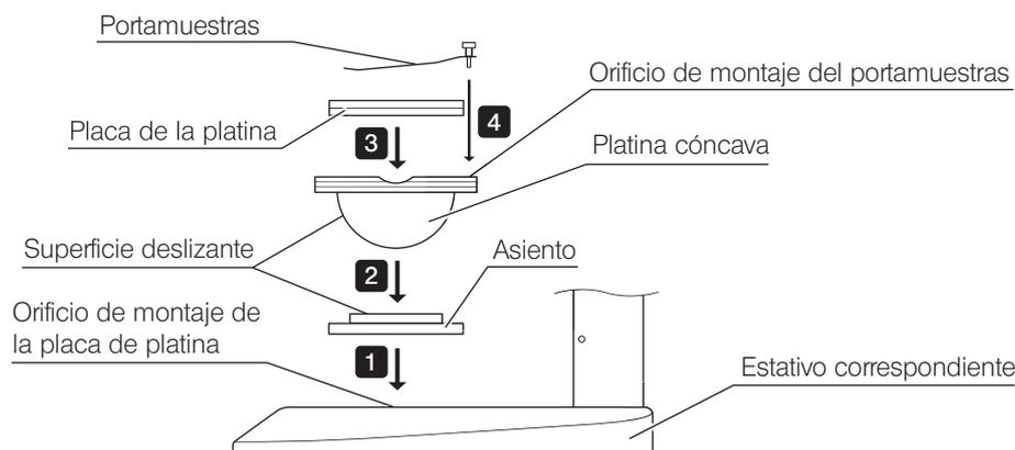
**1** Coloque el asiento de la platina cóncava en el orificio de montaje de la placa de platina de un estativo correspondiente.
