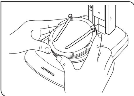
**1** Coloque una muestra en la placa de platina, sostenga la platina cóncava por el borde e inclínela lentamente.
