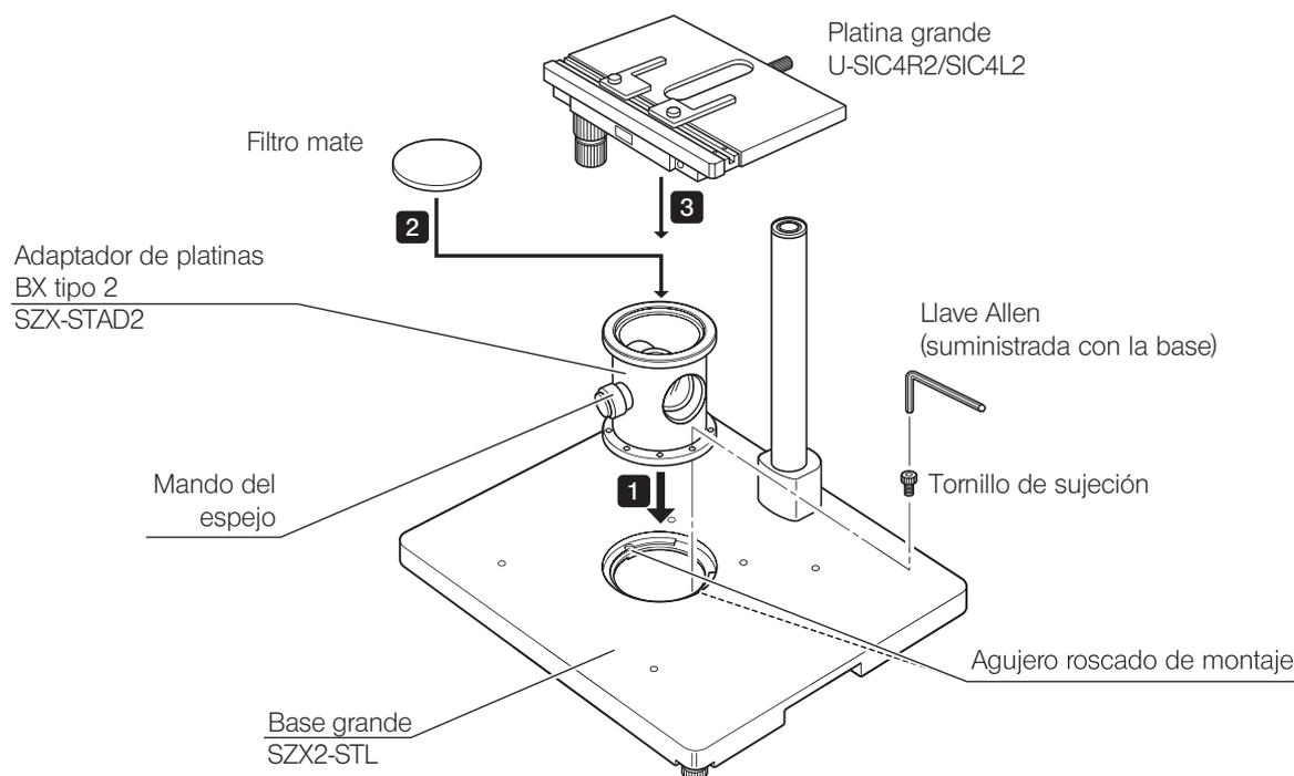
**NOTA** Para una observación de luz transmitida simplificada, coloque el mando del espejo en la parte delantera y utilice un filtro mate.
