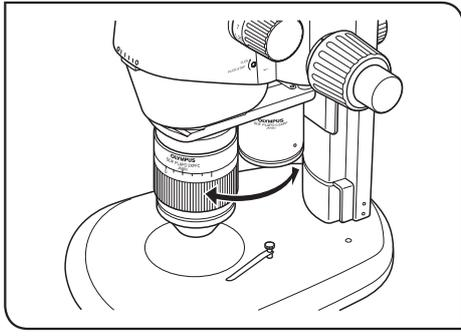
Sujete el objetivo y gírelo con suavidad hasta una posición de clic de la parte delantera en la que el objetivo a utilizar quede interpuesto en la trayectoria de luz.
