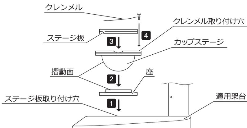
**1** カップステージ座を適用架台のステージ板取り付け穴に挿入します。
