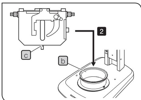
**2** BH2-SH(水平ハンドルステージ)のステージ固定つまみ**c**を架台の正面にして、固定つまみ**c**を時計回りに回して固定して、BH2-SHを取り付けます。
