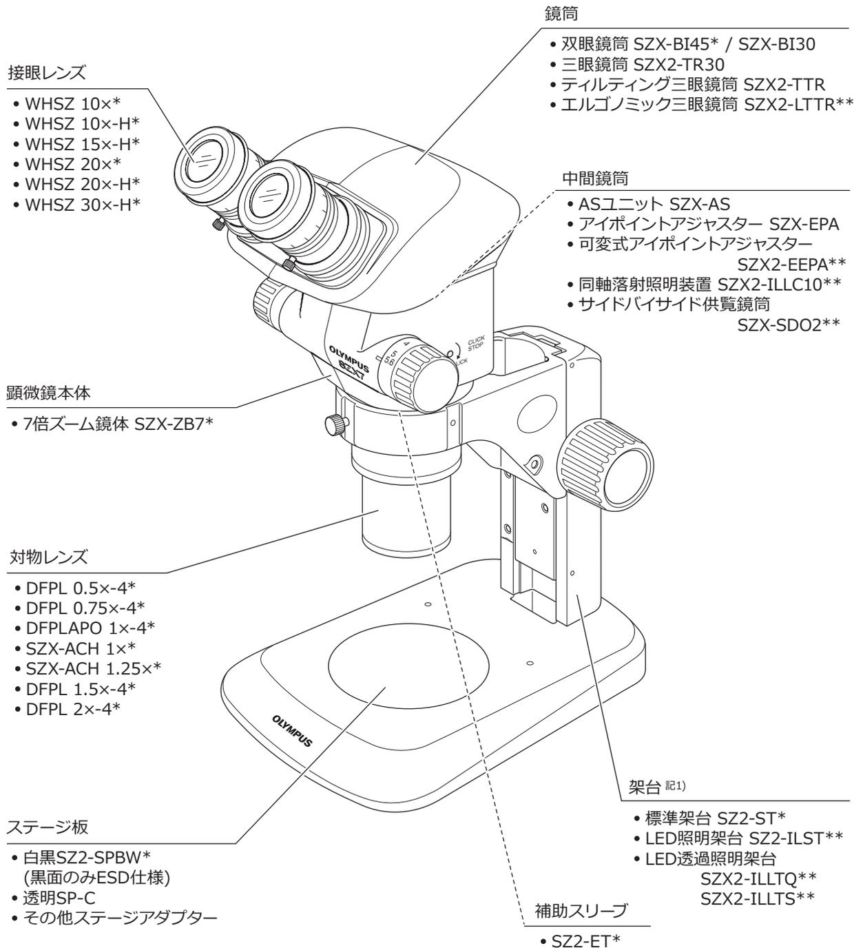
記1) 大型の架台シリーズ SZ2-STU1/STU2/STU3 や SZX標準架台 SZX2-ST などにも、焦準アーム SZ2-STB1/ SZ2-STC の併用で取り付け可能となります。
