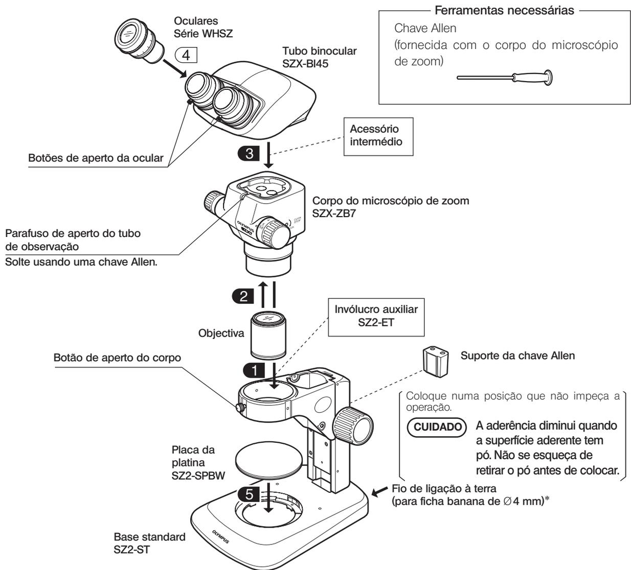
\* Para que a protecção de descarga electrostática (ESD) funcione, ligue o equipamento à terra por meio de um fio terra com ficha banana de 4 mm.
