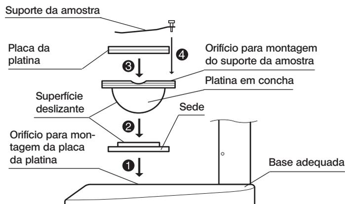
1. Monte a placa em concha no respectivo orifício para montagem de uma base adequada.
