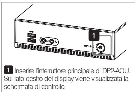
**1** Inserire l'interruttore principale di DP2-AOU. Sul lato destro del display viene visualizzata la schermata di controllo.
