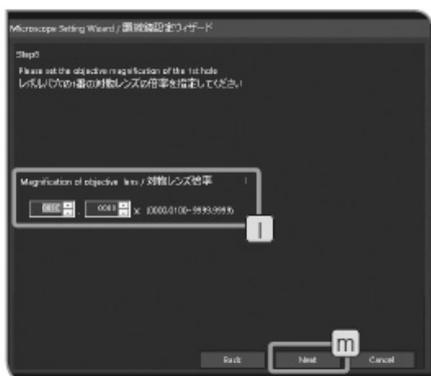
**7** 将光路中的物镜的放大倍率设置为 **l**，并按下[下一步]按钮 **m**。
