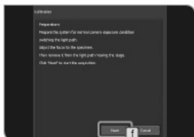
**5** 使用相机时，将光路更改为标准曝光状态，并按下[下一步]按钮 **f**。校正开始。
