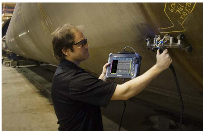
Omniscan SX は TOFD 検査にも対応しています。TOFD は、溶接部の欠陥をすばやく効率的に検出することができる検査法で、溶接部内部の欠陥やサイジング、製造時欠陥の疑いのあるエリアを効率良く測定します。
