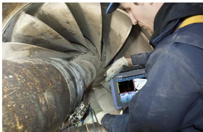
超音波検査は、部品のきず、減肉、その他の欠陥の検出に最適です。Omniscan SX は、斜角ビームや垂直ビームを生成することができるため、シングルグループ構成の探傷において、機能、コスト面ともにパフォーマンスに優れています。
