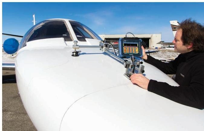
Omniscan SX は、垂直探傷にも対応しています。腐食や複合材の検査として、現場で実証済みの欠陥検出、減肉検査におけるソリューションを提供します。
