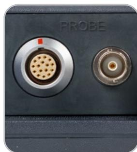
Der LEMO-Anschluss (16-polig) unterstützt auch die NORTEC POWERLINK Technologie, die codierte Sonden erkennt und das Gerät automatisch entsprechend der Sonde einstellt, um die Konfiguration zu beschleunigen.
