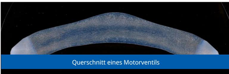
Querschnitt eines Motorventils
