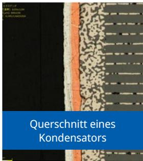
Querschnitt eines Kondensators
