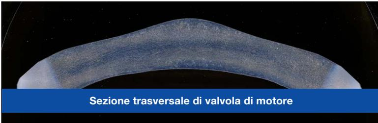
Sezione trasversale di valvola di motore
