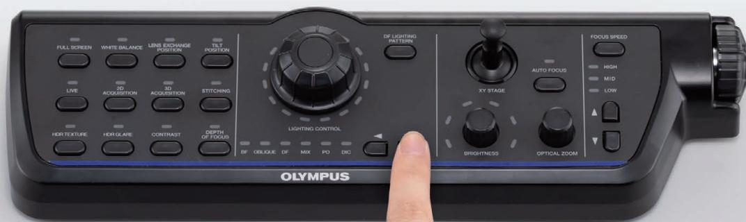
Il microscopio DSX1000 offre la flessibilità di agevolare e velocizzare il flusso di lavoro d'ispezione. Per cambiare osservazione è sufficiente ruotare una manopola, mentre per commutare il metodo di osservazione tra i sei disponibili basta premere un pulsante.
