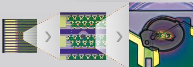
Der Vergrößerungsbereich von 20X bis 7000X des Mikroskops ermöglicht leistungsstarke Übersichtsbeobachtungen mit hoher und geringer Vergrößerung, um nahtlos zum Mikrometerbereich zu zoomen und dort detaillierte Analysen vorzunehmen. Mit der Schärfentiefe und einem langen Arbeitsabstand können auch größere Objekte untersucht werden, während das Freiwinkel-Mikroskopsystem die Betrachtung des Objekts aus vielen Richtungen ermöglicht.
