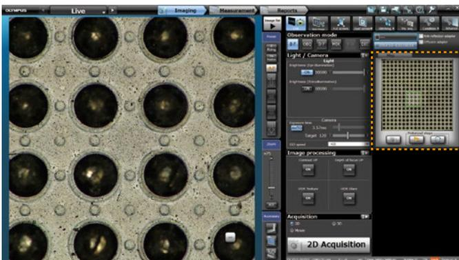
Für einen Überblick während der Prüfung. Das System zeigt den aktuellen Prüfbereich im Gesamtbild an, auch im Vergrößerungsmodus.
