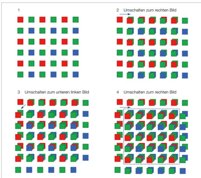
Mit dem DSX1000 System kann die gleiche Bildqualität erreicht werden, wie mit einer Kamera mit drei Kameraplatten zur Bildaufzeichnung, nach Verschieben der Sensorposition.
