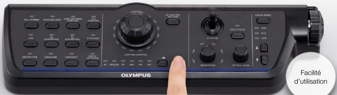
Le microscope DSX1000 offre une grande souplesse qui accélère et simplifie votre processus d'inspection. Il vous suffit de tourner une molette pour changer la perspective, et d'appuyer sur un bouton pour changer de méthode d'observation parmi les six offertes.
