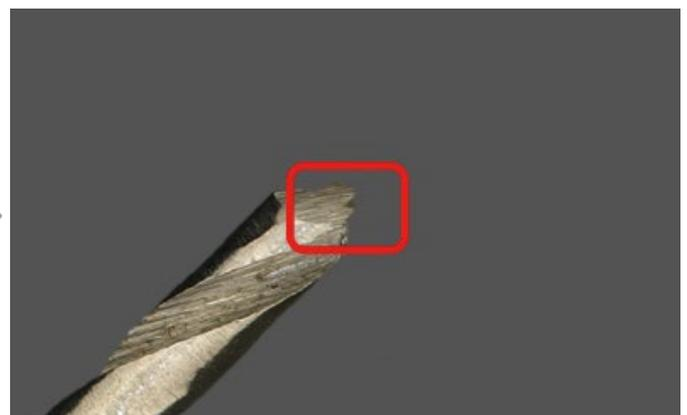
Grâce à l'éclairage plat, il est facile d'observer une surface endommagée (x24) au moyen du DSX1000.
