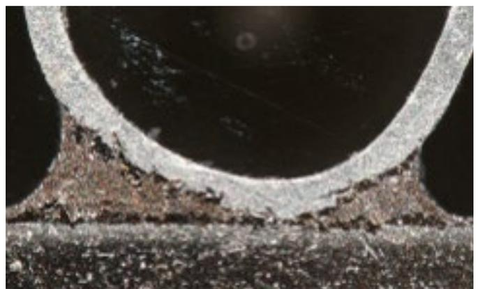
Grâce à la méthode d'observation par polarisation du DSX1000 (x300), voyez clairement le délaminage de la soudure.
