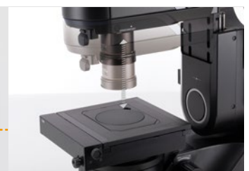
Mova rapidamente o tubo de zoom ajustando o botão de foco fino
