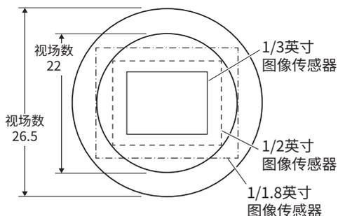
**参考** 作为参考，图示使用视场数22或视场数26.5的目镜时的视野范围以及通过通用型C型相机座连接筒所取得的各图像传感器尺寸的成像视野的范围；
