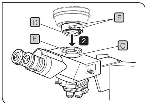
**2** 使用显微镜随附的六角改锥拧松三筒镜筒的照相机端口的固定螺丝**C**，然后将通用型C型相机座连接筒的安装燕尾槽**D**插入到三筒镜筒的照相机端口**E**。
