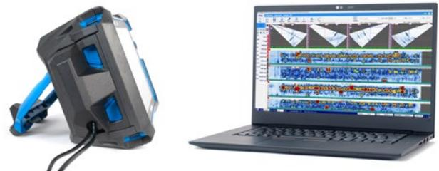
Para proteger el instrumento contra el ingreso de objetos externos al conectarlo al *software* de PC WeldSight, se ofrece la siguiente tapa opcional para fines especiales: OMNI-A-X3-SPDOOR [Q1000230].
