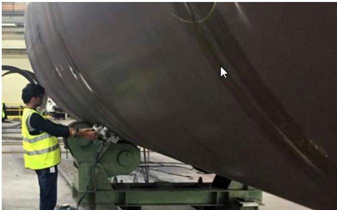
Adottata come alternativa alla radiografia (RT), la nostra avanzata soluzione di controllo phased array (PA) con software WeldSight migliora l'efficienza dei controlli di saldature di tubazioni e di recipienti in conformità alle norme ASME, ISO e altre norme simili. Ispeziona i materiali austenitici come le tubazioni rivestite e le saldature di metalli eterogenei utilizzando le nostre sonde phased array 1D e le sonde phased array TOFD e DLA/DMA
