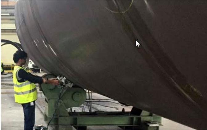
Usado no lugar da radiografia (RT), nossa solução avançada de teste Phased Array (PA) usando o software WeldSight melhora a eficiência dos testes de solda de tubulações e reservatórios em conformidade com ASME, ISO e normas de fabricação semelhantes. Inspeção de materiais austeníticos, incluindo tubulações revestidas e soldas metálicas dissimilares usando nossas sondas Phased Array 1D, de tempo de voo de onda difratada e Phased Array DLA/DMA.
