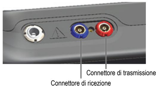
**Figura 2-2 Connettori LEMO codificati cromaticamente**
