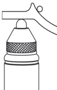
Obrázek 4-15 Nepřesné měření v důsledku existence překážky bránící pohybu cílové kuličky
