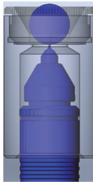
Obrázek 4-7 Vzájemné vyrovnání kotouče a hrany zploštělého hrotu
